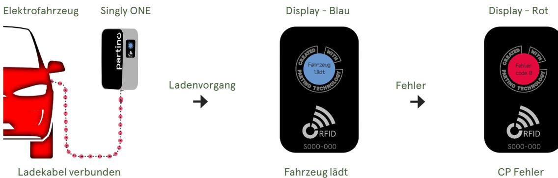
\*Das CP-Signal (Control Pilot-Signal) steuert die Kommunikation zwischen Fahrzeug und Ladestation und gewährleistet die Sicherheit des Ladevorgangs.
