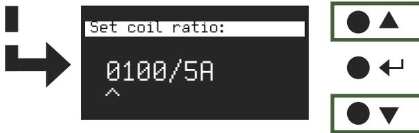
Mit UP können Sie den Wert schrittweise erhöhen. Mit DOWN können Sie den Wert schrittweise reduzieren. Mit der Taste ENTER springen Sie zur nächsten Ziffer.
